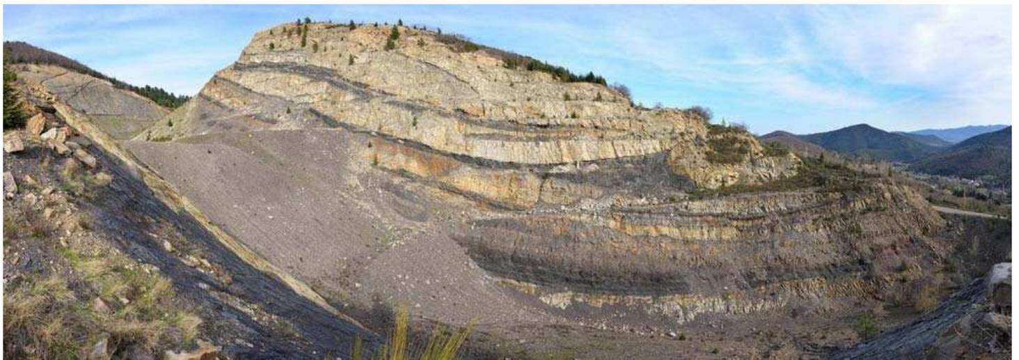
Figure 7 Quatre couches de charbon (cyclothème) sont visibles sur ce front de taille qui fait plus de 50 m de hauteur à Graissessac, Hérault. (Photo Association clin d'œil Bernard Henry Graissessac)
