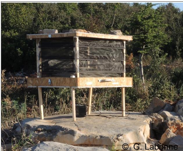
Figure 3 : Piège de type Tavoillot utilisé sur le domaine des Blaquières.
