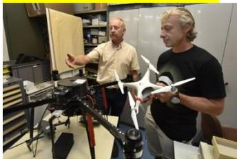
Trois drones peuvent être armés en fonction des missions : du plus léger jusqu'à l'octocoptère (drone à huit moteurs) qui peut emporter 7 kg de charge utile et plusieurs dispositifs de mesure et prélèvement simultanés...
