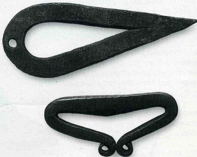
Pour produire des étincelles les briquets doivent être réalisés dans un acier trempé à forte teneur en carbone.
