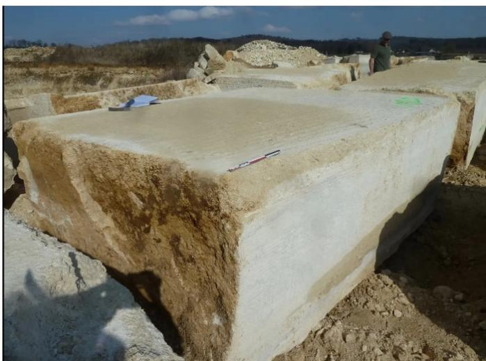
Première étape de contrôle de la qualité et de mesurage (« toisé ») des blocs, dans la carrière de la Croix-Huyard à Bonneuil-en-Valois (77) © BRGM - D. Dessantier
